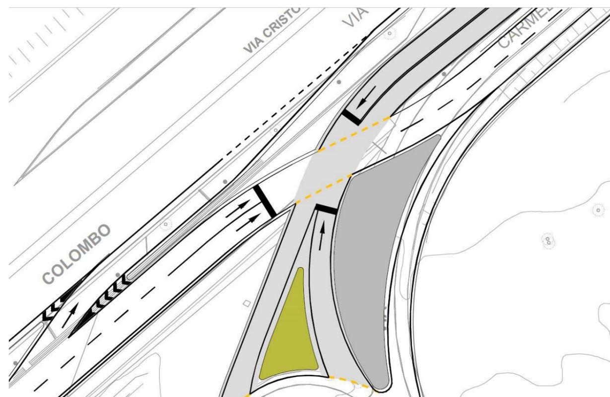
**Figura 1-7: intersezione semaforizzata complanare Colombo-Corridoio**
