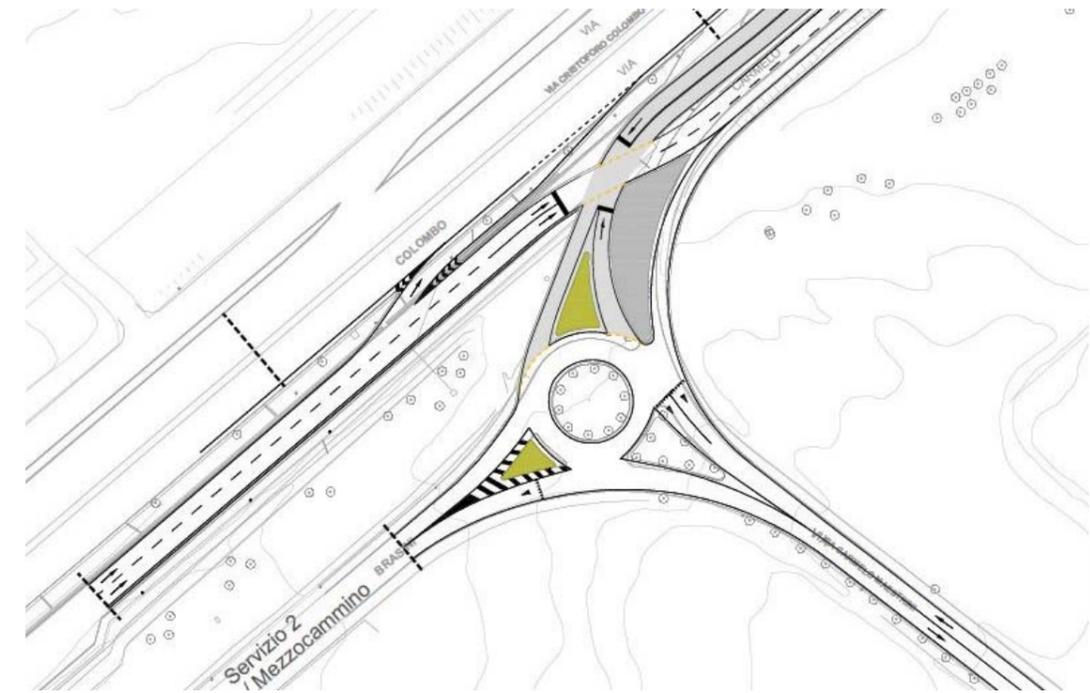
Figura 5-4: sistemazione planimetrica rotatoria Maestrini ed innesto complanare Colombo
