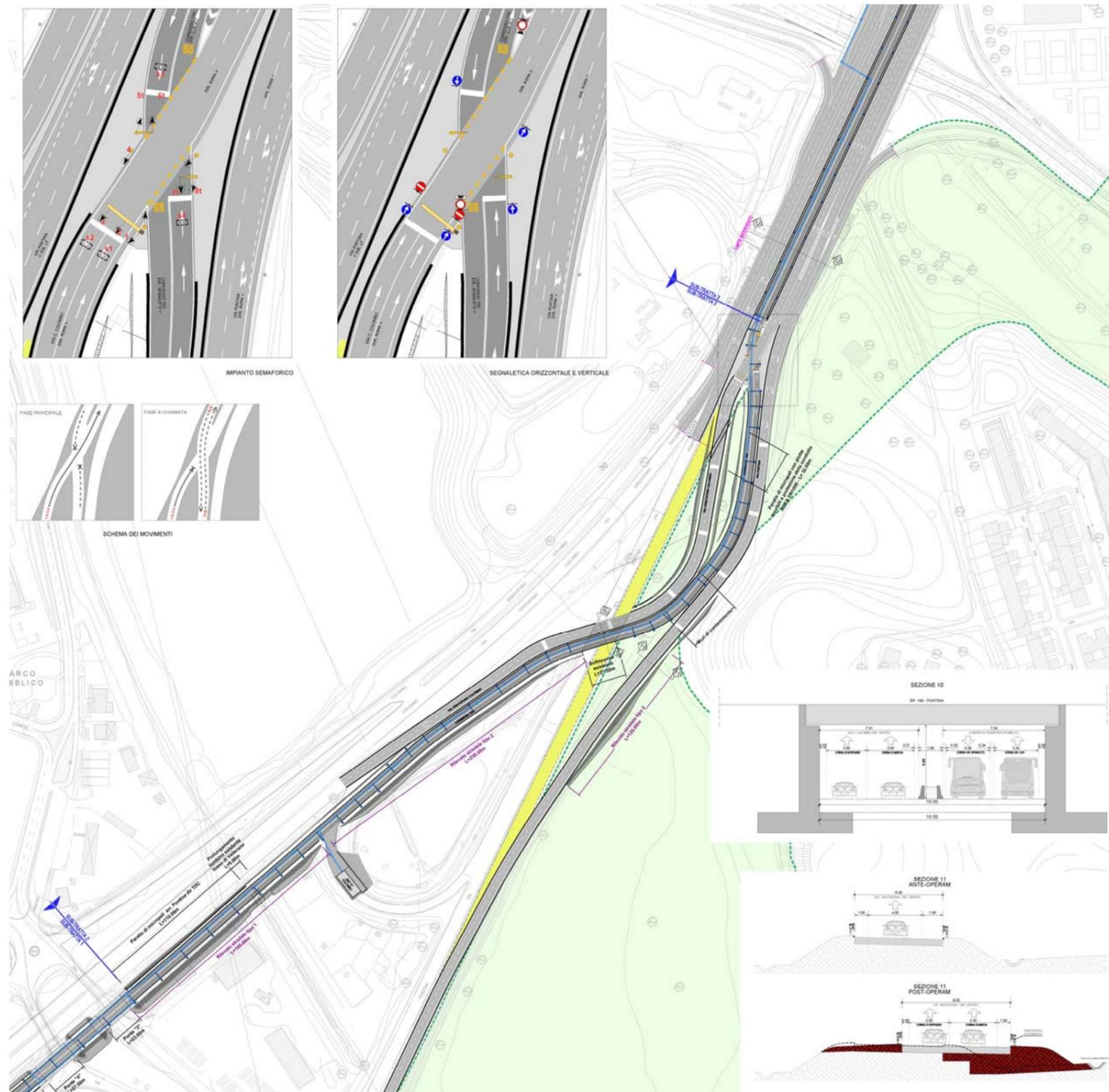
Figura 4-9 – Variante di tracciato - Conferenza di Servizi 14.07.2017 – Intersezione semaforizzata
