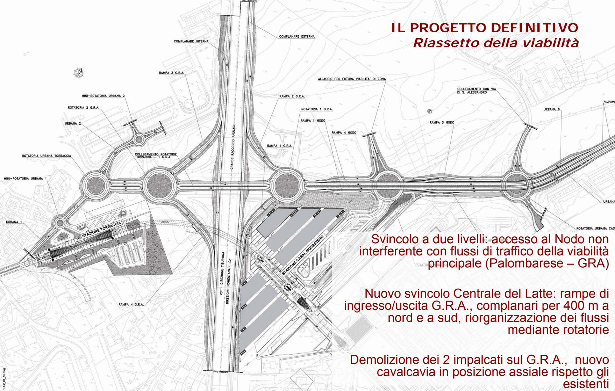
**Svincolo a due livelli: accesso al Nodo non interferente con flussi di traffico della viabilità principale (Palombarese – GRA)**
