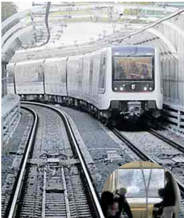
Uno dei nuovi treni della Metro C inaugurata ieri. A fianco l'interno, che è senza conducente
